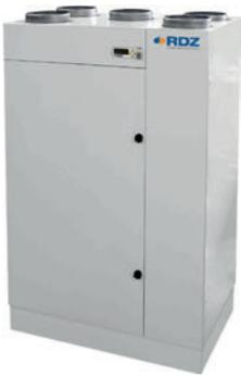
Unità verticale per il trattamento dell'aria: rinnovo aria con recupero di calore ad alta efficienza (~90%) e trattamento di deumidificazione estiva, con impostazione portata aria esterna ed eventuale funzionamento in totale o parziale ricircolo. La portata dell'aria di rinnovo, da 100 a 400 m<sup>3</sup>/h, è impostabile tramite il pannello utente, rilevata e mantenuta automaticamente.
